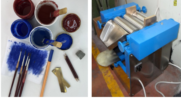
15 Vals cihazı ve sırüstü uygulamalarda kullanılan araç ve gereçler
